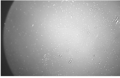
图 7 10 倍显微镜下薄膜表面质量
